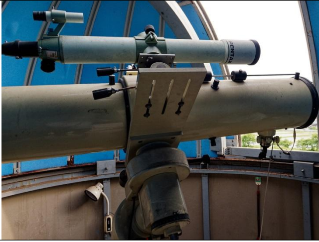
M 宅のドーム内部の反射望遠鏡（300mm、F6）と屈折望遠鏡（105mm、F9.5）
